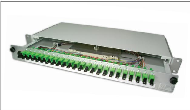
Die 19"/1 HE Lightbox ist eine 2-teilige Spleiß- und Patchbox zur Aufnahme von bis zu 48 Fasern auf 1HE, welche auch für den Einsatz als Verteiler für optische Koppler- und WDM-Module entwickelt wurde.
